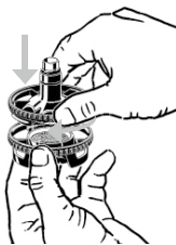
Visser le Couvercle de la Chambre de Remplissage
