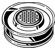
Die in den Dosierkapseladapter eingesetzte Dosierkapsel
