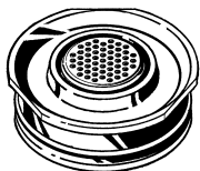
La Cápsula Monodosis incrustada en el Adaptador de Cápsula Monodosis
