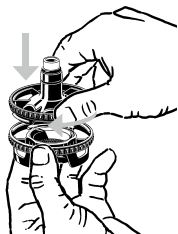
Enroscar la Tapa del Depósito
