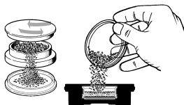
Enchimento da câmara de enchimento
