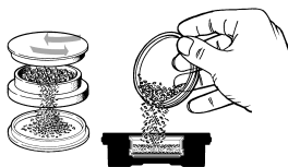
Napełnianie komory napełniania
