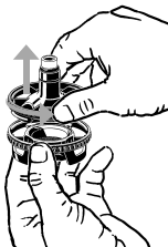
Sejmutí víčka Šachty
