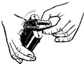
Retirar la Unidad de Enfriamiento (con la Boquilla)
