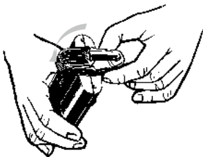
Rimuovere l'Unità di Raffreddamento (con il Boccaglio)
