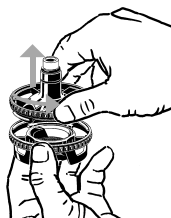
Αφαίρεση του καπακιού του θαλάμου πλήρωσης
