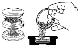
Πλήρωση του θαλάμου πλήρωσης
