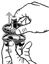
Αφαίρεση του καπακιού του θαλάμου πλήρωσης
